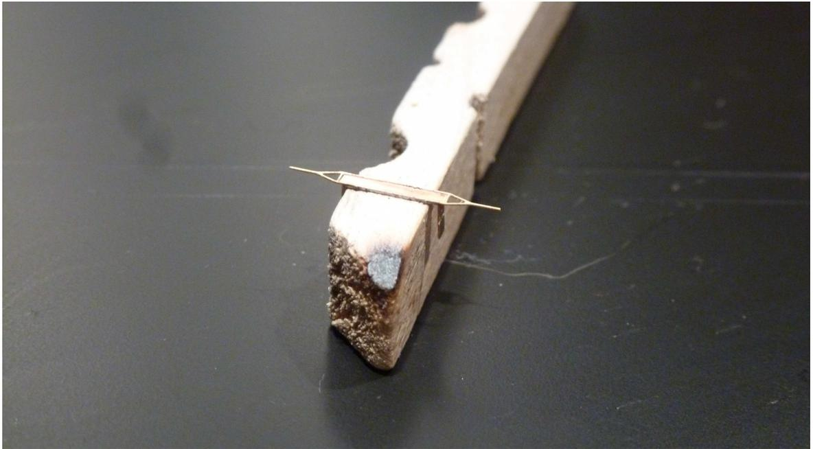
4. Limer les deux bords longs de la palette pour faire disparaître tenons de dégrappage et de pliage. Replier à 90° la platine « anti-rotation » du support. Couder les extrémités de palettes
