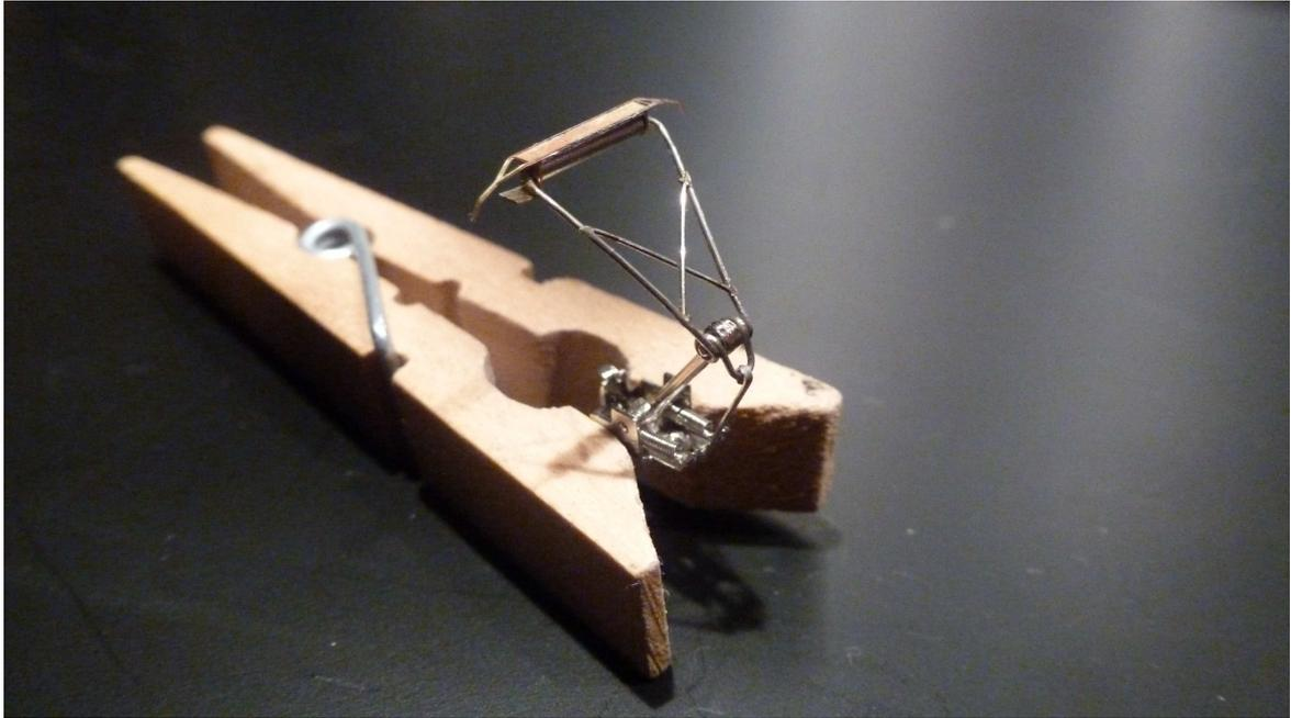
6. Il n'y a plus qu'à peindre et remonter le pantographe sur la locomotive
