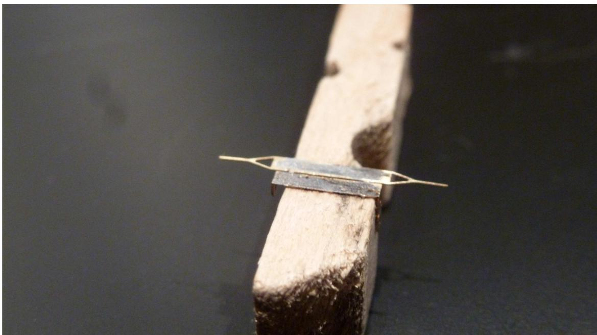
3. Replier la palette sur le support et souder. Il est également possible de renforcer les pattes de fixation du support avec un léger apport de soudure à l'intérieur de l'angle
